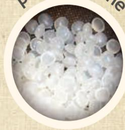
エルココは、コーンスターチを主原料とし、ポリプロピレンを混合して水蒸気のかで発泡します。材料面での環境負荷が小さく、また燃焼カロリーが低いため、焼却処理が可能※。植物由来原料を50%以上使用しているため、カーボンオフセット (CO<sub>2</sub>排出量削減) にも貢献できます。
